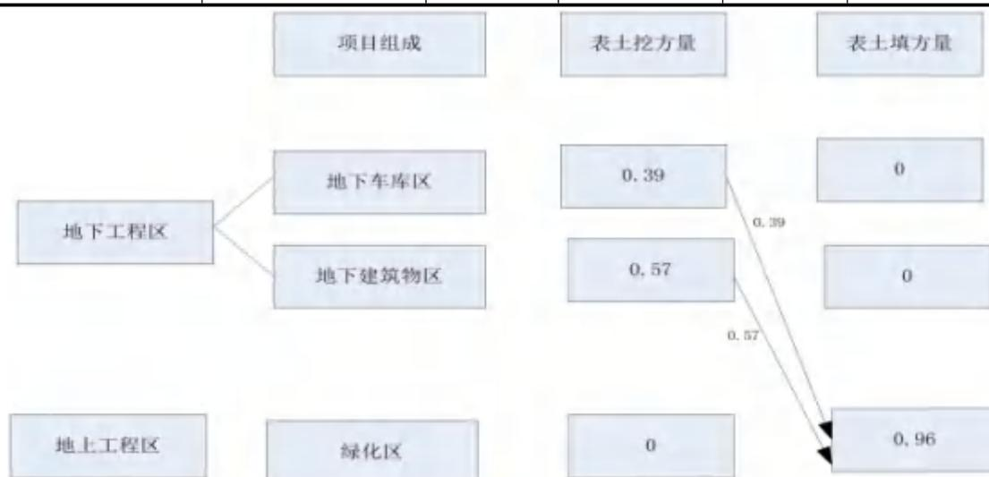
图 2-4 土石方流向图  $\text{m}^3$
